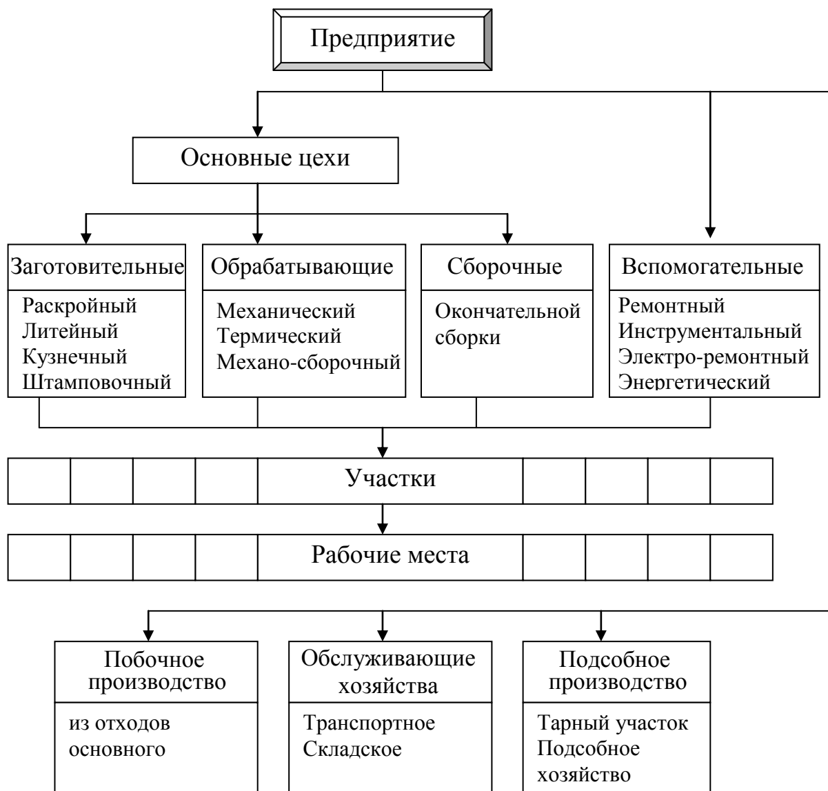
Рис. 3.14. Производственная структура среднего машиностроительного предприятия
