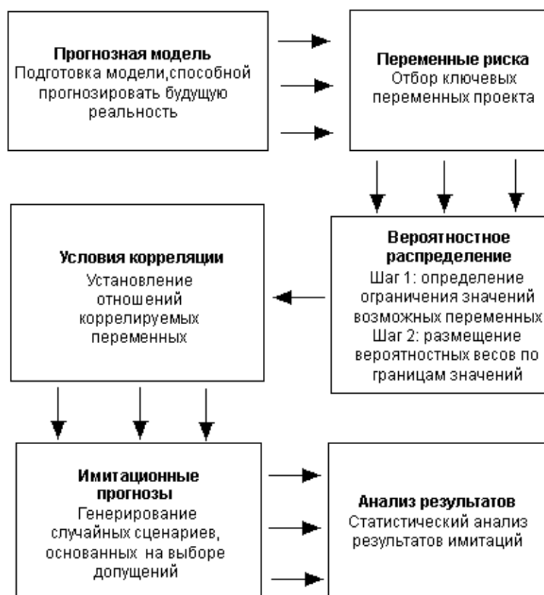
Рис. 6.4 Блок-схема последовательности действий в методе Монте-Карло
