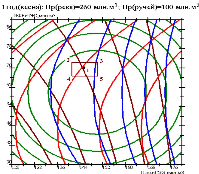
Рис. 38. Номограмма оптимизации «водной системой «А»:1-й год-весна.
