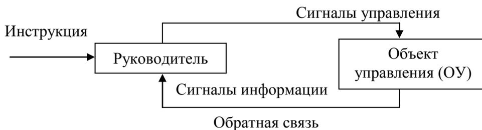
Рис. 4. Схема неавтоматического (ручного) управления объектом
