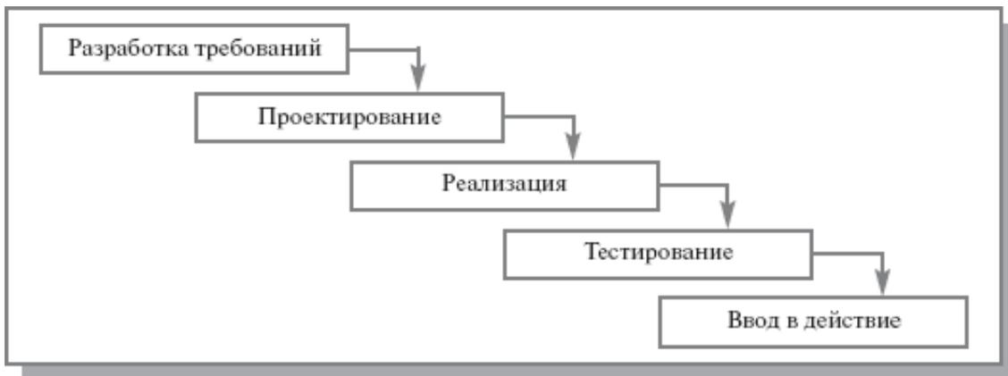
Рис. 2.5. Каскадная модель ЖЦ ИС
