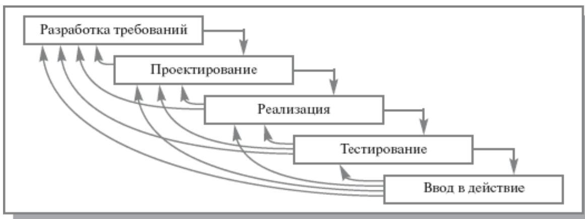
Рис. 2.6. Поэтапная модель с промежуточным контролем
