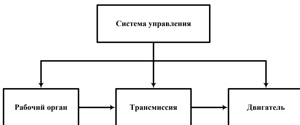
Рис. 1.2. Модель технической системы по Г.С. Альтшуллеру
